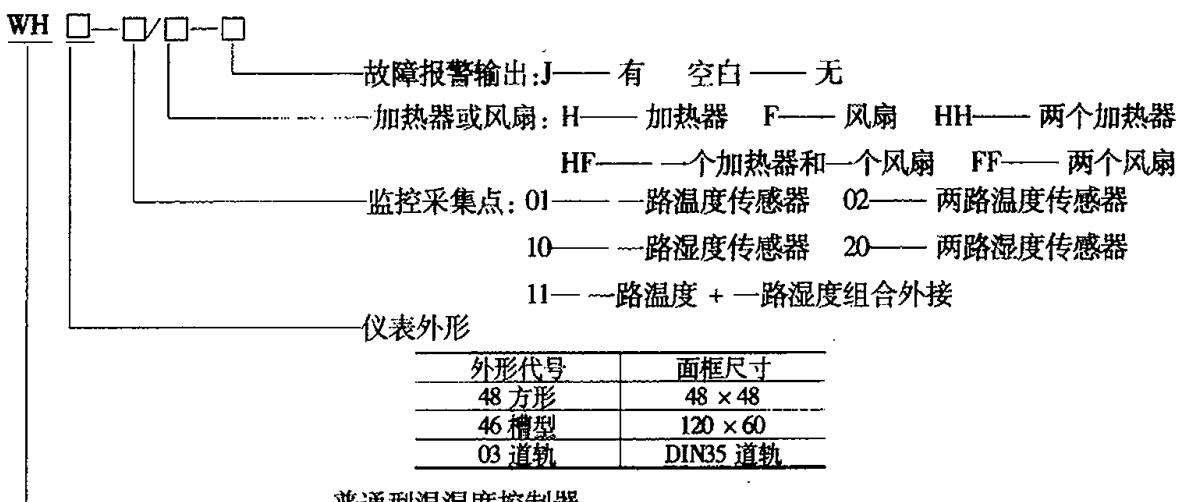
说明：“组合外接”即同时有温度、湿度控制时，传感器置于同一外壳，由同一点采集温度、湿度信息。
