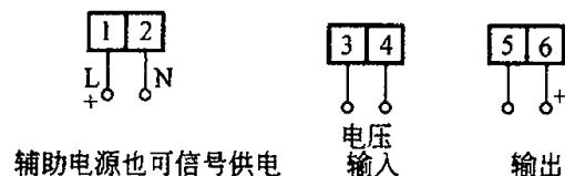
图 231 BD—F 频率变送器接线图
