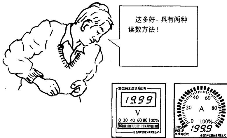
图 9 具有模拟光柱显示的数字电工仪表
