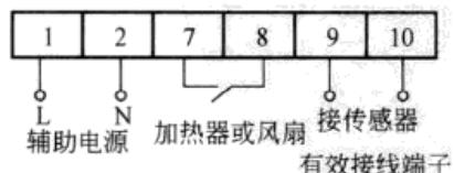
图 334 WH 普通型温湿度控制器 A 种接线图
